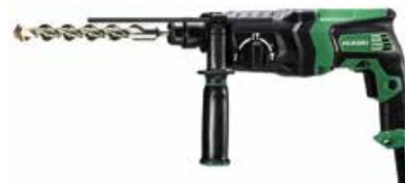
MARTILLO COMBINADO DH26PC2 SDS PLUS – 830 W - Peso: 2,8 kg - 2,9 J (según EPTA) - 3 modos de uso: perforar, perforar con percusión y ligeras demoliciones en pared. Embrague de seguridad.
